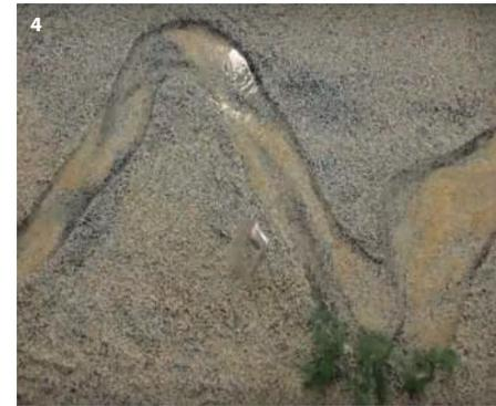
4. Modello fisico dinamico dell'ansa di un fiume durante una piena / Dynamic physical model of a river bend during a flood event
